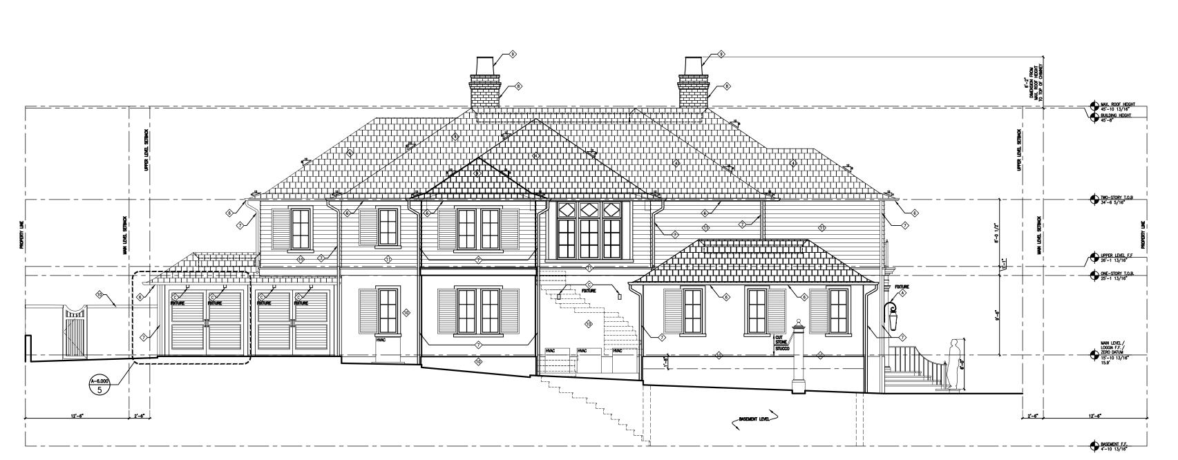
EXTERIOR MATERIAL LEGEND ○ BM - OC 149 - DECORATORS WHITE ② BM - 2128-40 OXFORD GRAY 4 LUDOWICI CENTURY SHAKE IN EARTH GRAY 5 LIMED CYPRESS 6 COPPER 1/2" ROUND GUTTERS COPPER 4" DIAMETER DOWNSPOUTS SAVANNAH GRAY BRICK VITRIFIED CLAY CHIMNEY POT — WELLINGTON — SUPERIOR CLAY CORP
